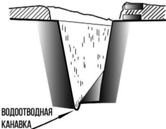
Рис. 2. Водоотводная канавка на дне траншеи
